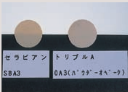
図5 AAAのオペークとセラビアンのシェードベースの透過性の比較。色調はA3。シェードベースには、メタル色を遮蔽する、という役目はないためオペークに比べやや透過性がある(透過光にて撮影)。
