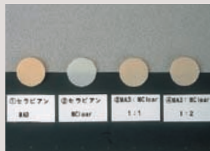
図7 左より、①セラビアンのマージンポーセレン(MA3)、②セラビアンのマージンポーセレン(M-Clear)、セラビアンのマージンポーセレンのMA3とM-Clearを③1:1、④1:2で混合したもの。
