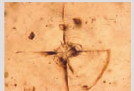
図9 セラビアンのビッカース硬さ試験の状態。周波上の亀裂やめくれがほとんどない。
