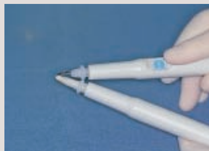
図21-2 金属チップ・参照電極を接触させてから測定する
