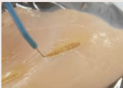
図6 鶏肉の下に対極板を置いて切開する。図5と同じように切開できる。
