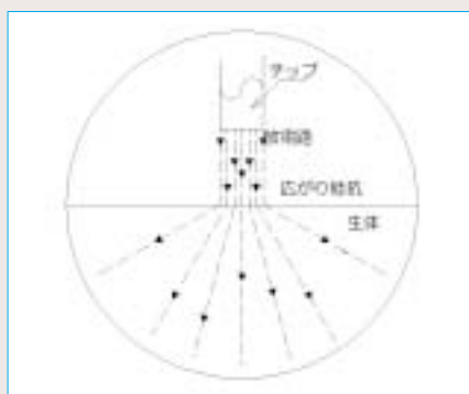
図1 生体表面に大きな電気抵抗が生じ、高いジュール熱が発生する。
