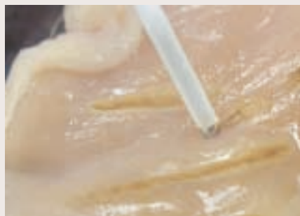
図8 止血用のチップも試してみる。本体のモードを止血に合わせ、ラウンド状の止血用チップを用いて鶏肉に接触させると、表面が凝固する。
