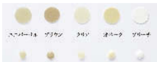
写真9 クリアフィル エステティック セメント ペースト硬化物とクリアフィル エステティック セメント トライイン ペーストの色調比較
