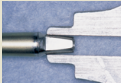
図25 ノギスで軸面の角度とアンダーカットの有無をチェックする。
