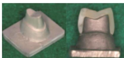
図7 迫口らは規格化された金属支台に、規格化されたCAD/CAMレジン冠を各社レジンセメントで装着し、より臨床に近い状態を再現した<sup>13)</sup>。
