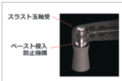
図5 スラスト玉軸受とペースト侵入防止機構の透視図。スラスト玉軸受によって軸方向に圧力が加わっても摩擦抵抗を減らして回転をスムーズにしている。また、ペースト侵入防止機構でペーストの侵入を防いでいる。
