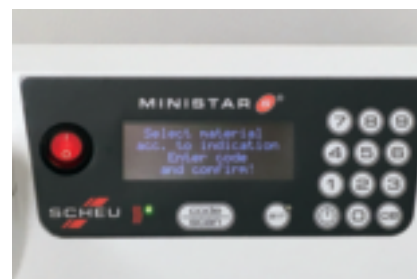
図5 コード入力可能となったコントロールパネル。
