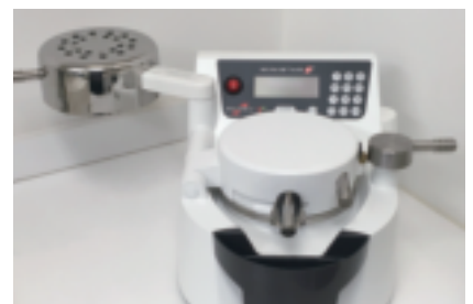
図14 加熱終了とともにチャンバーを180°回転させて模型に被せる。加熱した面が模型に圧接できるので適合精度が高くなる。
