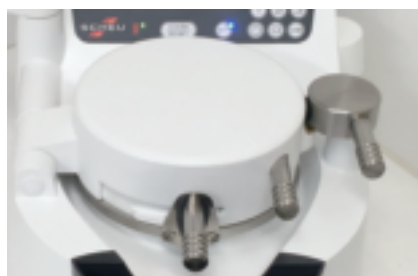
図15 ロッキングハンドルによりロックすると自動的に加圧が始まる。一連の操作を素早く行うように心がける。
