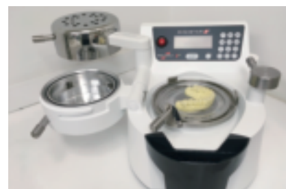
図17 ロッキングハンドルを後方に戻した後、ロッキングリングを解除して、チャンバーを元に戻す。これですべての成形工程が終了である。
