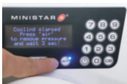
図16 加圧、冷却が終了するとアラームが鳴り、airボタンがブルーに点滅するので、ボタンを押して排気する。デジタル表示部にも必要な指示が表示される。
