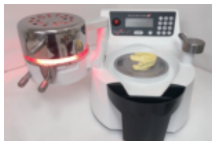
図13 赤外線ヒーターをプレート上にスライドさせると加熱が始まる。操作は簡単である。
