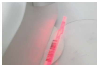
図4 バーコードスキャンによる加熱・加圧・冷却時間の設定。
