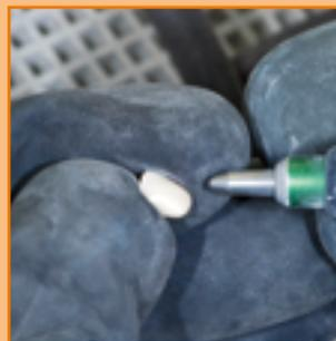
図6 2気圧以下でアルミナ50 $\mu$ mのサンドブラスト処理をおこなう。
