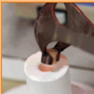
図12 ワックスの焼却後、インゴットHを湯口側にセットし、その上からディスボランジャーを挿入する。
