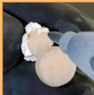
図14 ガラスビーズ50 $\mu$ m・最大2気圧で埋没材を取り除いているところ。マージン方向からブラストノズルを当てないよう注意する。
