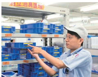
各モジュールの製作に必要な治具を収納する「組立治具棚」。毎日使用する治具にも品質管理を徹底し、製品のムラが出ないようにしている。
