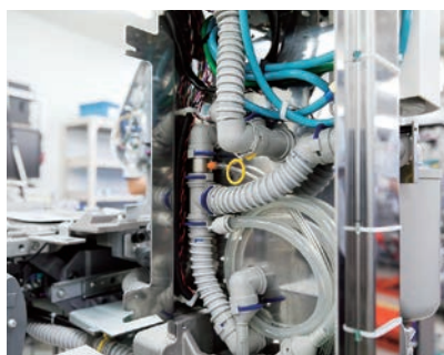
ベースの組立の様子。結合部分は全てクリップとOリングによるパッキン止めで行い、ほとんどのモジュールはワンタッチで着脱することができる。
