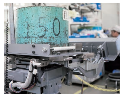
昇降・起伏の荷重テストを行う。座面には150kgの負荷をかけ、設定通り動作するかを確認する。
