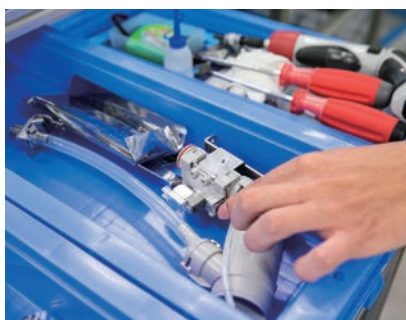
組み立てられた部品はボックスに収納する。こうしてモジュール化された部品が200種類以上組み合わされて1台のスペースラインが完成する。
