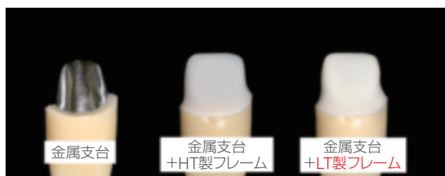
図3 HT製フレームとLT製フレームの比較(フレームの厚みは0.4mm)
