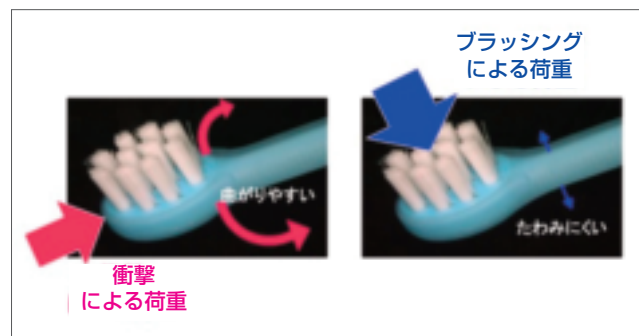
図8 左：転倒時の曲がりやすさ 右：歯みがき時のたわみにくさ
