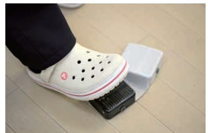
図10 無線式の2ペダル式フットスイッチは充電の必要も無く、使いやすい。
