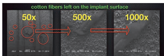
図3 綿球による除染は細部まで綿の繊維が入り込めないのみならず繊維がインプラント表面に残渣するという問題点がある。
