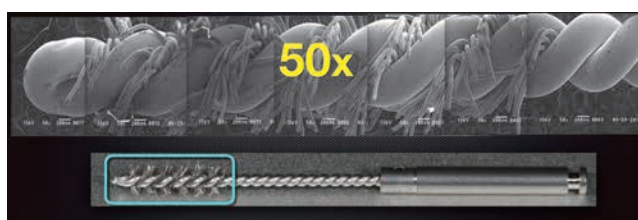
図4 チタンブラシの先端部分を電子顕微鏡で50倍に拡大した像。
