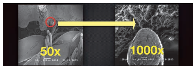
図5 チタンブラシの毛先をインプラント表面にタッチさせその部分を50倍、1000倍に拡大した図である。微細構造の中まで毛先が入り込めていないのが確認される。
