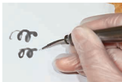
図2 感熱紙による練習。感熱紙表面が薄く黒く変色する程度にチップ先を2cmほど離し、直径5mmほどの円を描くように動かしながら照射する。
