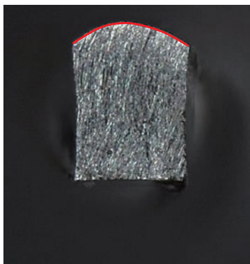
図5 「JIZAI」の断面。ラジアルランドを有した特徴的な形状。
