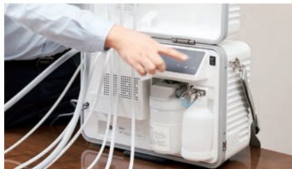
パネルに角度をつけ、真上からでも操作しやすいようにしている。
