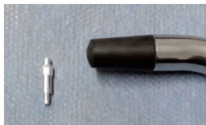
図2 プローブから磁気パルスを発信することで共振周波数を測定しISQ値を得る。
