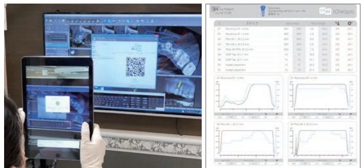
図6 データの入ったQRコードを瞬時に取り込みサージカルモーターに設定する(左)。QRコードを元に移行したデータから、実際の術中時の回転数、トルク値、注水量が時間経過とともに記録され、PDFとしてはき出せる(右)。
