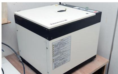
図1 「サーモトロールⅢ」はW460×D390×H390mmとコンパクト設計。ポンベ類が不要のため、限られたスペースにも設置が可能。
