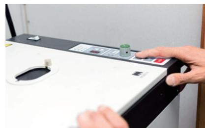
図3 メルトキーを押すと金属融解が始まる。高周波による高速昇温のため、短時間で金属が融解される。
