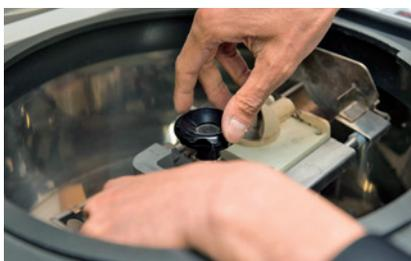
図2 メタルをルツボに投入後、回転の重心が回転軸にかかるようにバランスウェイトを調整。
