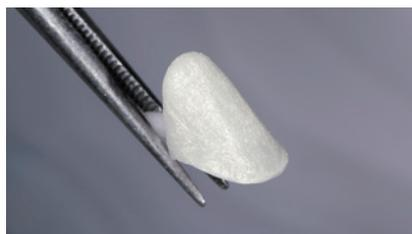
図8 ウォッシュアブライ。焼き付けを強固にするためにごく一層、薄くシェードベースオパークを塗布し、930 $^{\circ}$ C大気係留1分のスケジュールにて焼成する。
