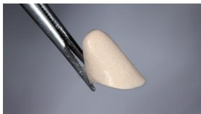
図11 焼成後の状態。焼成温度は図8と同じでよい。
