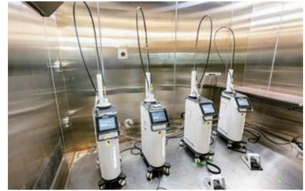
図6 温度-10℃~+80℃、湿度20%~95%の環境を設定できる恒温恒湿室で、使用・保管時の環境試験を行っている。
