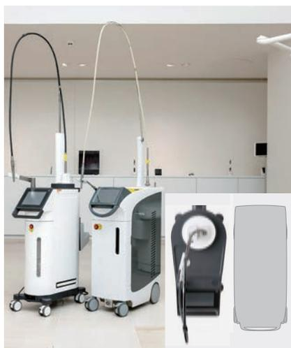
図1 左がアドベール SH。アドベール EVO (右)と比較して、設置面積:11%減、奥行:15%減、重量:20%減を実現。キャスターも4輪自在を採用し、可搬性もさらに向上した。
