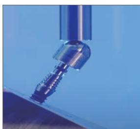
図3 実際のSPIインプラントに行われているISO14801応力試験の画像。ISO14801は、インプラントの疲労強度を比較する試験である。規定の角度に傾けたアバットメントを装着したインプラント体に対し、最大15Hzで振幅疲労加重を加える試験である。
