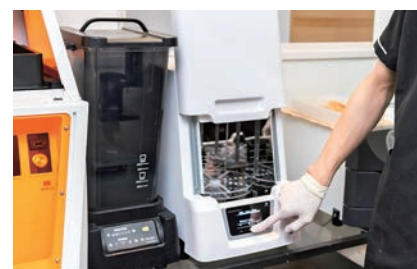
洗浄後に光重合を行う。「Accuprint 3D LEDcure」は、波長の異なる2つのLEDライトを装備しているため、さまざまなインクの光重合に対応する。
