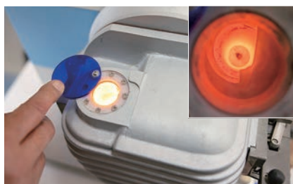
金属目視窓より融解の状況や鋳造のタイミングを確認する。
