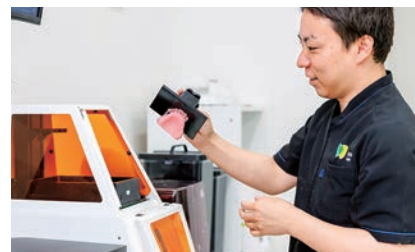
3Dプリンターで試適用の義歯をプリントしたところ。
