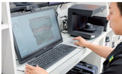
歯科用CAD装置「カタナシステム」を使って義歯のデザインを行う。
