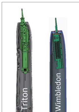
図4 ドライブレイン新旧比較 右側が「フィリップス ソニックアー 6100 プロフェッショナル」
