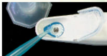
図12 ビベットで唾液を採取し、センサー部に滴下して、pH測定する
