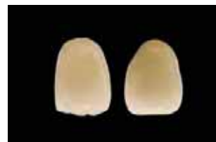
図4 ジルコニアクラウン(左)はメタルボンド(右)に比べ光を透過する。
